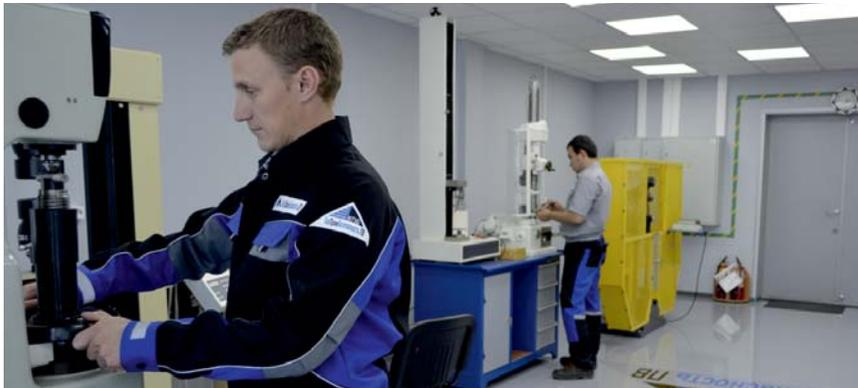
Лаборатория осуществляет: механические испытания материалов, сварных соединений и другой металлопродукции, а также металлографические исследования чёрных металлов и сварных соединений (микро и макроанализы, на стойкость к МКК) в лабораторных и полевых условиях.
