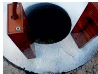
яются такие дефекты как: несплавления, трещины, неметаллические включения, волосовины, флокены. Выявление дефектов возможно в случае, если они выходят на поверхность изделия или расположены на малой глубине (не более 2-3 мм). Магнитные методы основаны на излучении магнитных полей вокруг места контроля.
